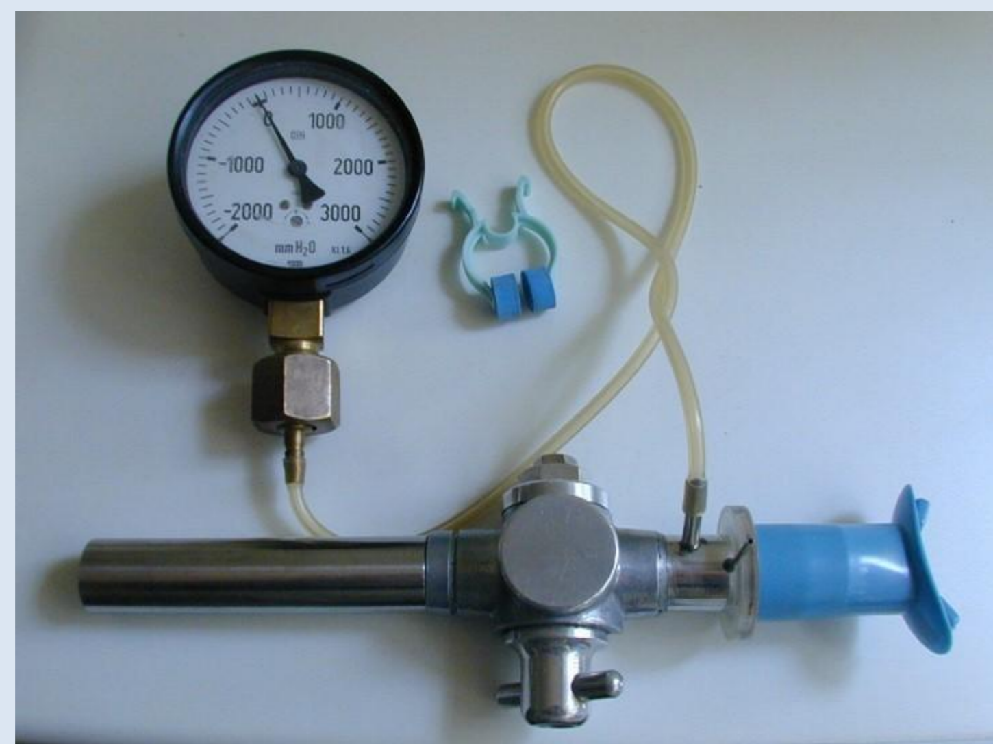
Γράφημα 1. Ημιάκαμπτο επιστόμιο με προεξέχον χείλος, προσαρμοσμένο σε μεταλλικό στέλεχος που σχηματίζει τρίοδη βαλβίδα, για την αξιολόγηση της ισχύος των αναπνευστικών μυών
